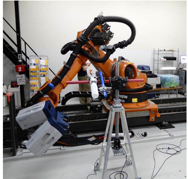
Fig. 1 RoboVib スキャニング振動計による測定の様子
