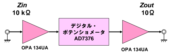
図 7 TDT 社のアッテネータ (PA5) の構成
